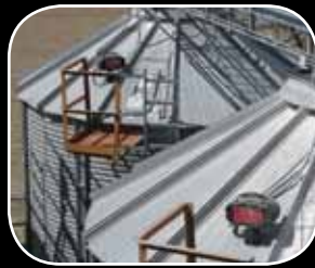
Midiendo maíz dentro de un silo de almacenaje para grano.
